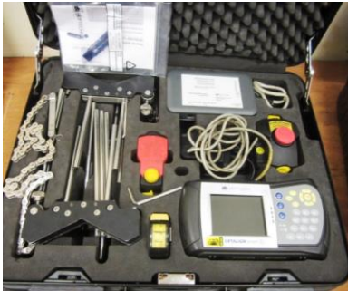
DB Pruftechnik Optalign Smart precision laser alignment
