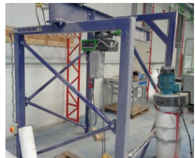
Stahl ST210-8/2 1/1 1000KG hoist and frame
